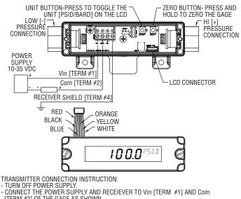
[TERM #2] OF THE GAGE AS SHOWN. INSTALL THE LCD'S CONNECTOR TO THE GAGE AS SHOWN.
